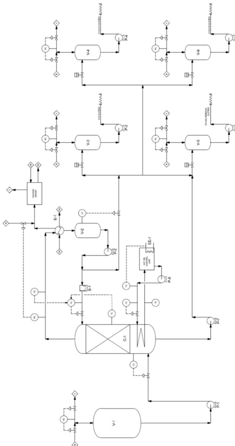
Figura 1 – Schema impianto pilota di distillazione batch
