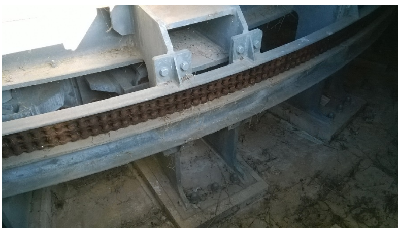
Fig9- Catena sulla guida circolare per la movimentazione di azimuth nella vasca sotto la copertura metallica dell'eliostato.
