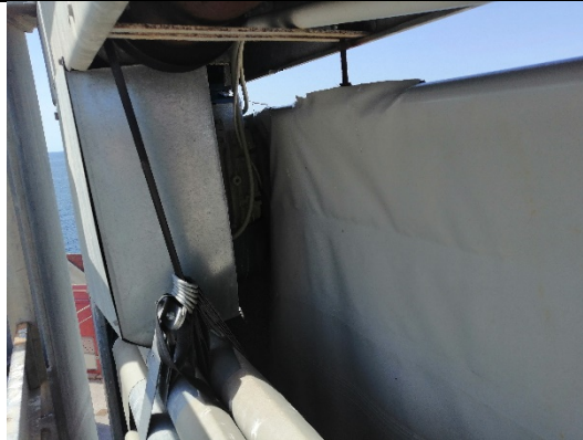
Figura 24 Motoriduttore collocato nella parte superiore del "Paraboloide"
