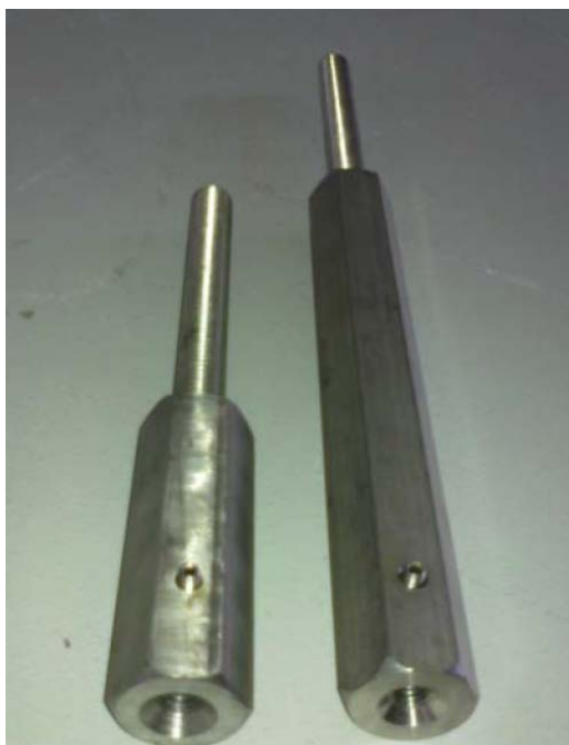
Fig.15- Distanziali filettati (tipo corto e tipo lungo) utilizzati per il montaggio degli specchi piani: in primo piano si vedono l'estremità filettata internamente attualmente avvitata nei perni uscenti dai supporti ed il grano per il fissaggio, mentre in secondo piano si vedono le estremità filettate esternamente impegnate nei fori della struttura metallica dell'eliostato
