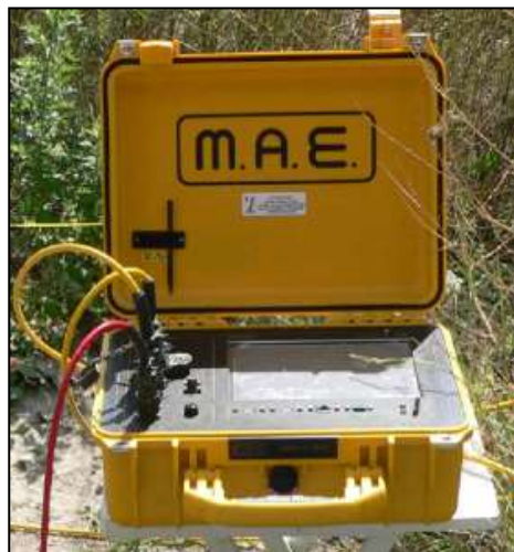
Fig. 3: sismografo multicanale M.A.E. modello A 6000 S.
