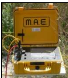
Fig. 2: sismografo multicanale M.A.E. modello A 6000 S.
