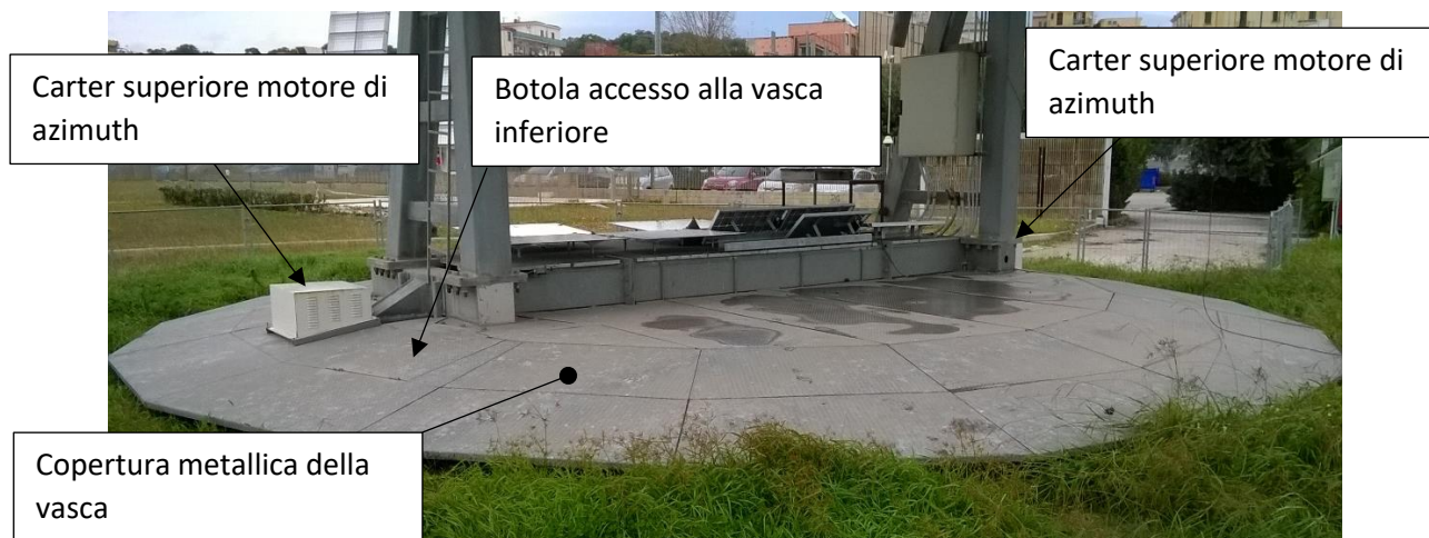
Fig7- Parte inferiore della struttura dell'eliostato che ruota intorno all'asse centrale e verticale: sono visibili gli alloggiamenti dei motoriduttori, la copertura metallica che copre la vasca e la botola di accesso
