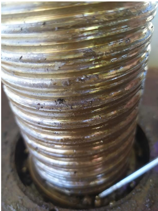
Fig2- Dettaglio del punto di innesto della vite nella chiocciola: sono visibili le sfere uscite dalla loro sede
