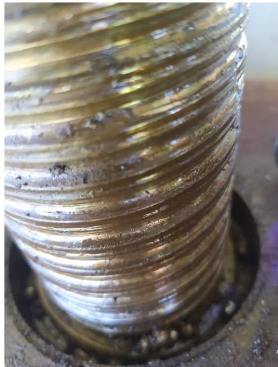
Fig2- Dettaglio del punto di innesto della vite nella chiocciola: sono visibili le sfere uscite dalla loro sede
