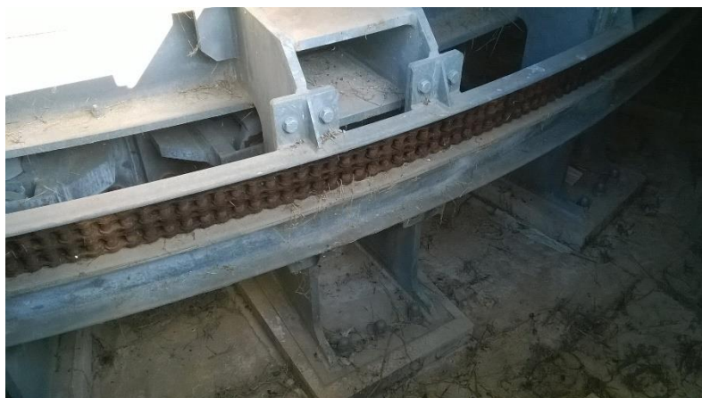
Fig8- Catena sulla guida circolare per la movimentazione di azimuth nella vasca sotto la copertura metallica dell'eliostato.
