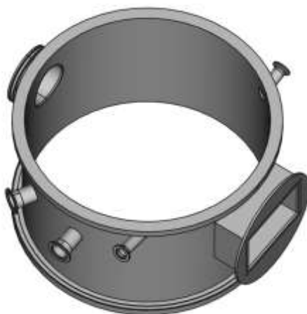
Figura 2 Flangia principale della camera di sputtering
