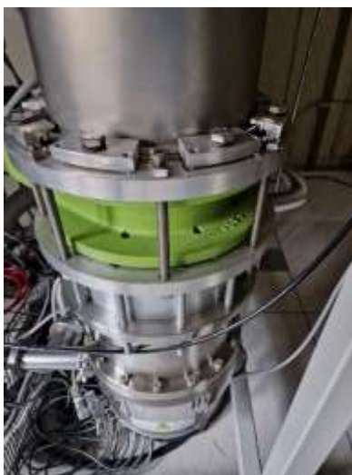
Figura 7 Attacchi flangiati fino alla pompa turbomolecolare
